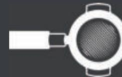
Alle unsere Maschinen sind standardmäßig mit Siebträgern mit einem Durchmesser von 54 mm ausgestattet. Bei der Kaffeeextraktion wirkt bei gleichem Eingangsdruck deutlich weniger Gewicht auf den Kaffeeboden als bei den klassischen 58 mm. Bei gleicher Kaffeemenge ergibt sich mit dem 54-mm-Siebträger ein höherer Kaffeeboden: Das heiße Wasser benötigt mehr Zeit, um durch das Kaffeemehl zu fließen – und das bei geringerem Druck. Das Ergebnis ist ein vollmundigerer Kaffee mit komplexeren Aromen.
